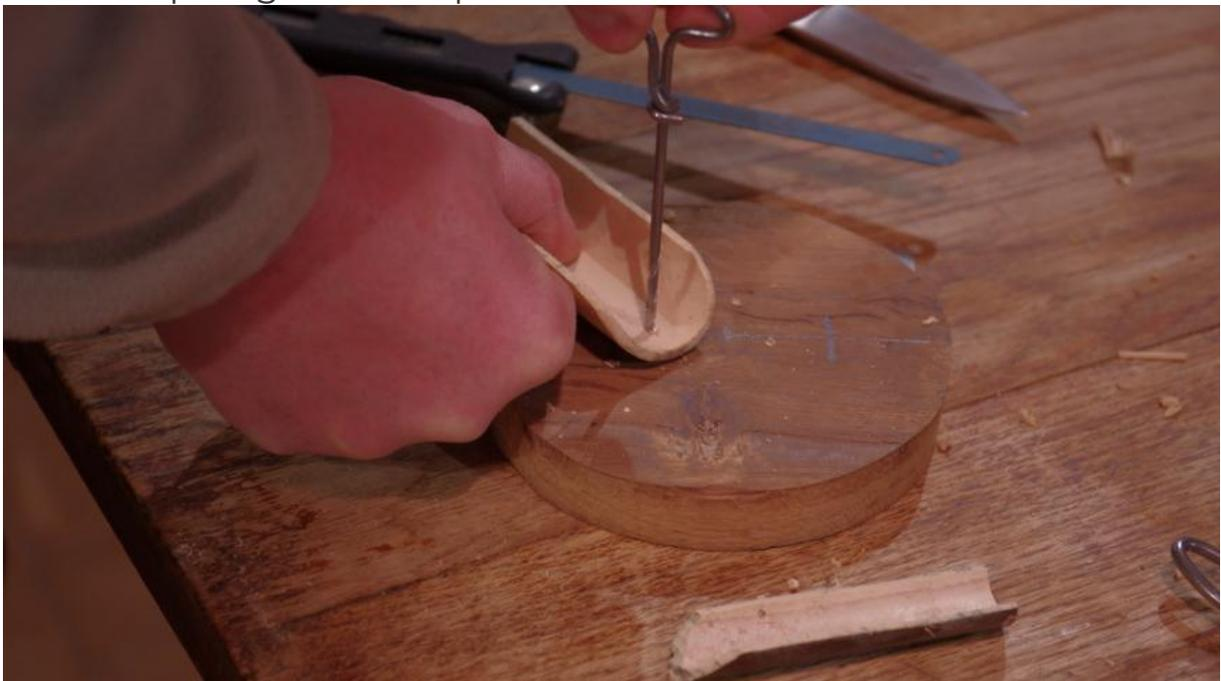
Percez le voltigeur d'un trou dans sa partie haute.
