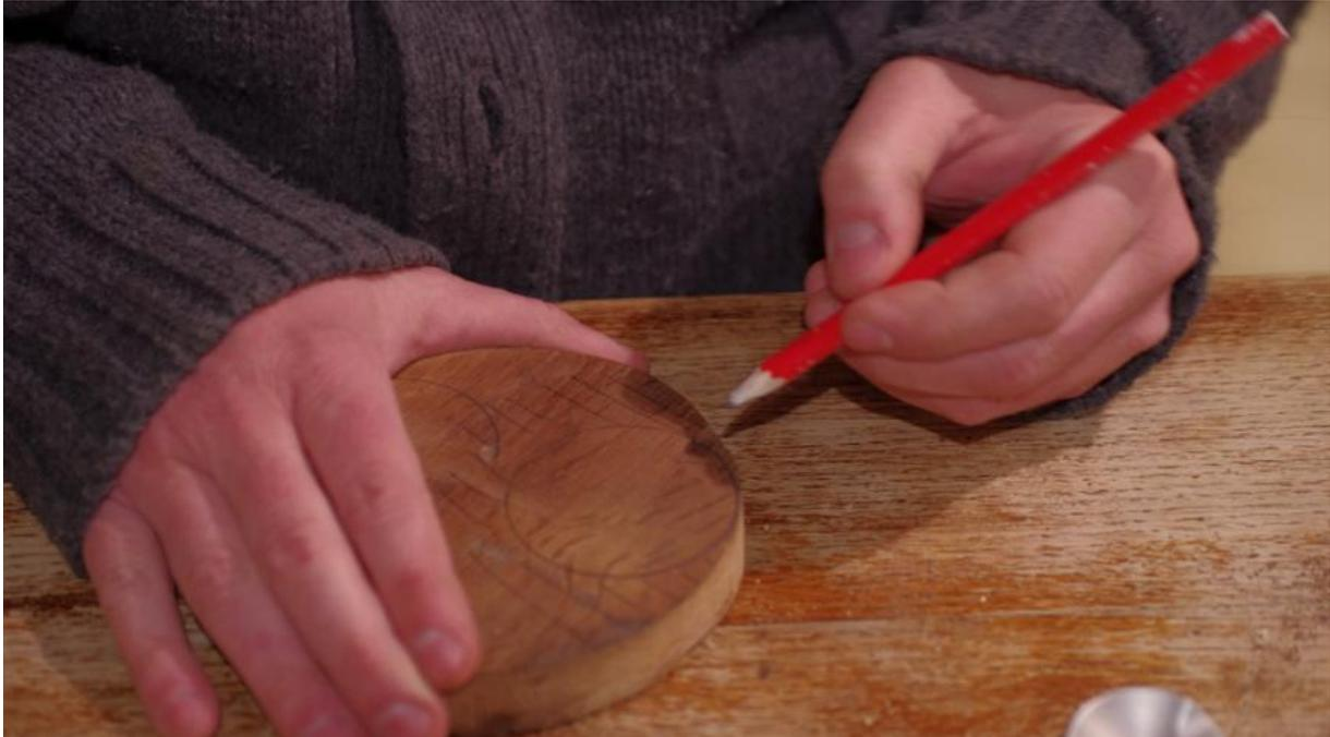
Sur une chute de bois – ou un essai raté comme celui-ci – tracez le marteau. Son diamètre est légèrement inférieur à deux diamètres de bambou. Soit, dans notre exemple, environ 5 cm (6 cm moins 1 cm). Découpez-le. L'idéal est d'utiliser un bois très dur (chêne, noyer, châtaignier...) pour obtenir un son plus clair, plus franc. Un bois tendre aura tendance à absorber le son, mais ce n'est pas une nécessité absolue.
