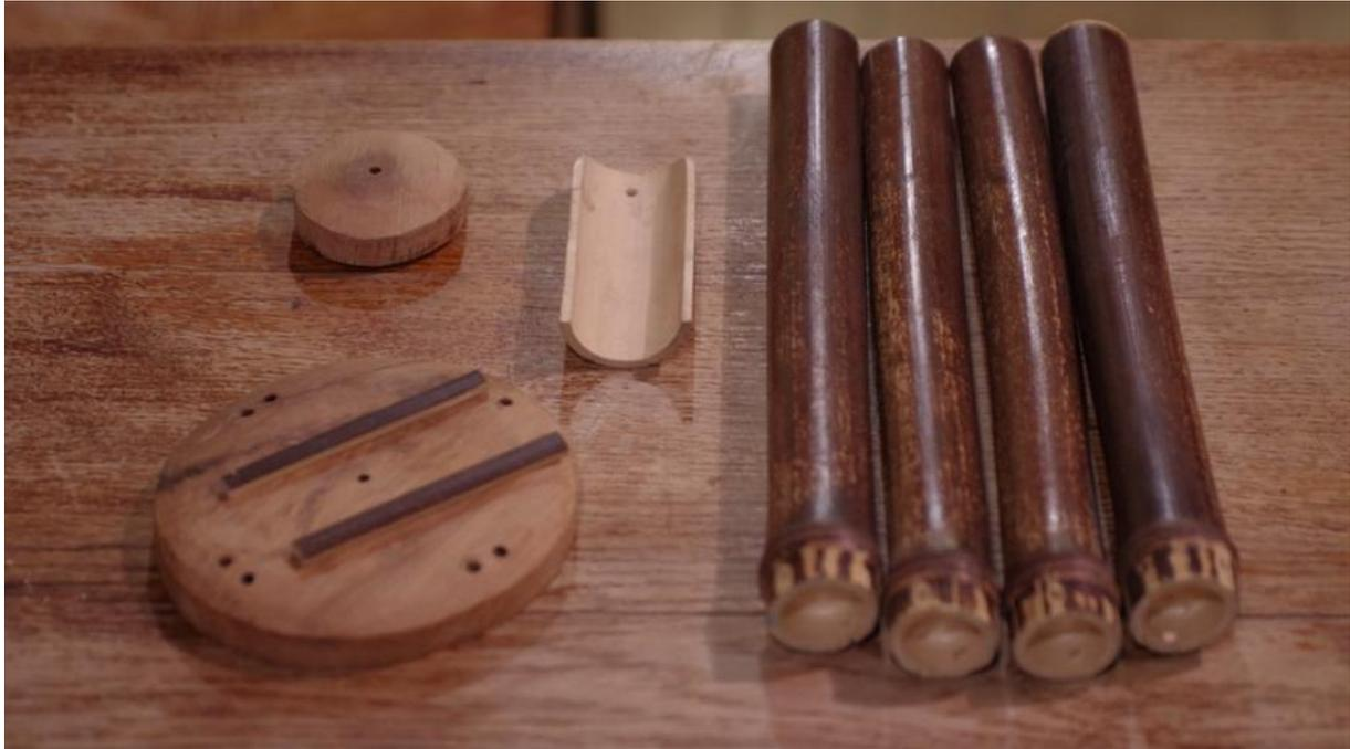
Un petit contrôle s'impose. Nous devons avoir 4 tiges de bambou, une galette, un marteau et un voltigeur. Sur la galette deux petites cales de bambous pourront servir plus tard pour régler certains détails. C'est maintenant que vous pouvez décorer ou figoler votre carillon. En rabotant les angles de la galette et du marteau, en arrondissant le voltigeur à l'aide d'un couteau, en découpant la partie basse des tiges pour en modifier la sonorité, en sculptant les tiges, etc.
