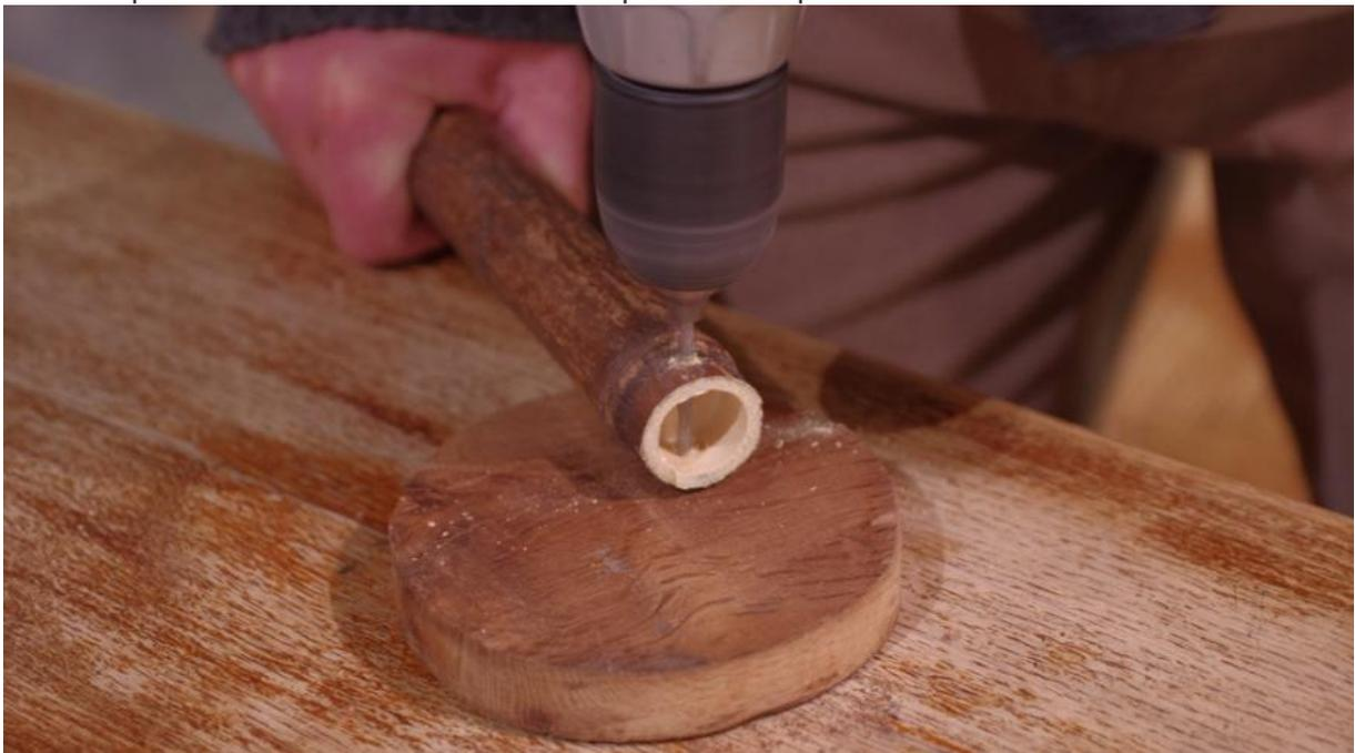
Percez à la perceuse (ou avec la vrille) pour traverser de part en part la partie au-dessus du nœud, nous y glisserons la ficelle pour le suspendre. Percez d'abord un côté, puis l'autre en retournant la tige, car si vous percez d'un seul coup les deux trous, il y a des risques d'éclatement de l'écorce en dessous.
